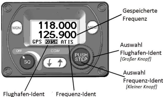
Mit Hilfe des großen Frequenzwahlknopfes kann die Liste der verfügbaren Flughäfen durchgeblättert werden. Mit Hilfe des kleineren Frequenzwahlkopfes kann die Liste der einzelnen mit diesem Flughafen verbundenen Frequenzen durchgeblättert werden. Nachdem Sie alle geladenen Flughäfen durchgegangen sind, oder falls kein GPS angeschlossen ist, wird der eingebaute Speicher des Bediengeräts angezeigt.
