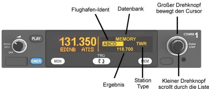
Flugplatz- und Anlagenkennungen sind nach alphabetischer Reihenfolge geordnet. Scrollen Sie durch die Kennungen durch, bis Sie die Kennung finden, die Sie brauchen. Beim Drehen des großen Knopfes können Sie den Cursor bewegen, um die Station hervorzuheben. Zum Beispiel GND, TWR or APPR.
